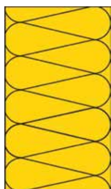
\lambda = 0,040 \text{ W/mK} 240 mm pl: ásványgyapot
