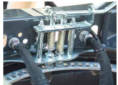
Stufenlos verstellbarer Drehkranz mit mechanisch lösbarer Sperre
