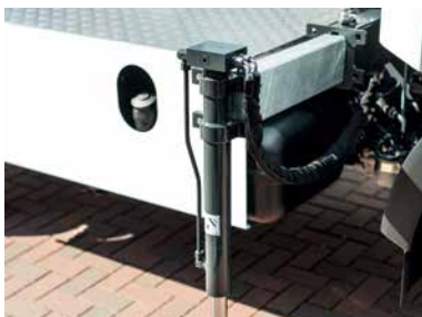
Hydraulische Stützen vorne optional ausziehbar
