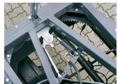
Optional mit hydraulischer Drehkranzverstellung
