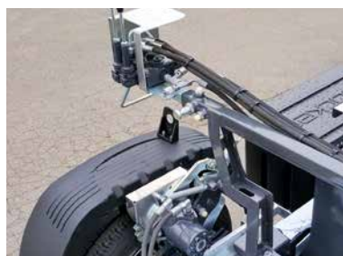
Formschlüssiger, leistungsstarker Selbstfahrtrieb (optional)
