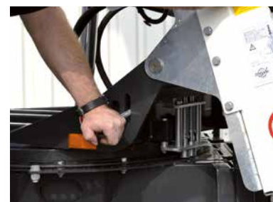
Verstellbarer Drehkranz mit mechanisch lösbarer Sperre
