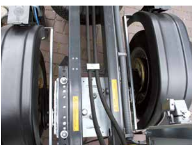
Einschiebbare Achse, Rangierbreite 0,89 m (optional)
