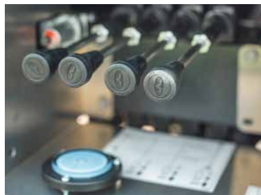
Steuerstand der hydraulischen Stützen
