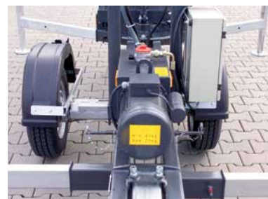
Einschiebbare Achse, Rangierbreite 0,89 m (optional)
