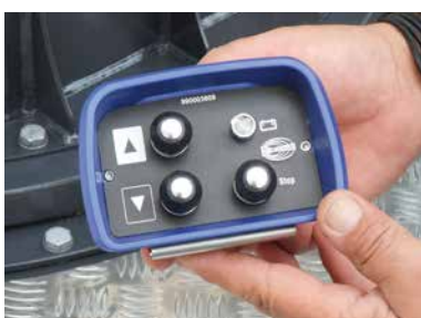
Optionale Bedienung unten über Funksteuerung
