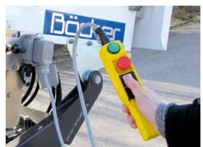
Bedienung unten über Bedienungstaster mit 4 m Kabel
