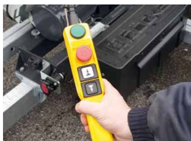
Elektrische Steuerung mit Schleifgang (optional)
