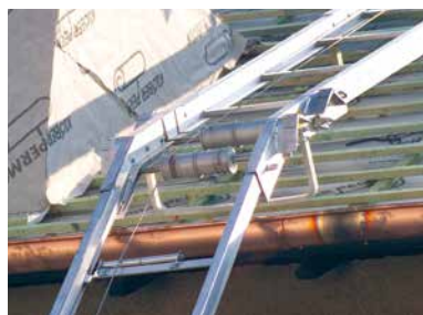
Integriertes oder mechanisch anbaubares Knickstück
