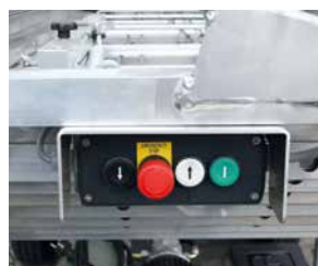
Elektrische Steuerung mit Schleichgang (optional)
