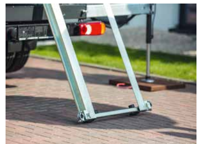
Bodentiefe Beladung möglich durch stufenlos ausziehbare untere Verlängerung
