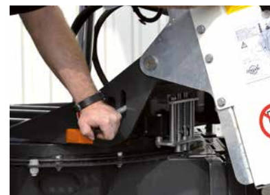
Verstellbarer Drehkranz mit mechanisch lösbarer Sperre
