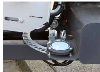
Mehrfach verstellbarer Drehkranz
