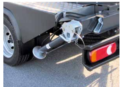
Hydraulische Stützen mechanisch ausziehbar und 60° schwenkbar
