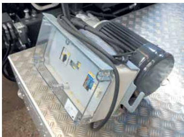
Zusätzlicher 230 Volt E-Motor (optional)
