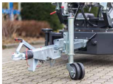
Stabiles Stützrad (optional als Doppelstützrad)
