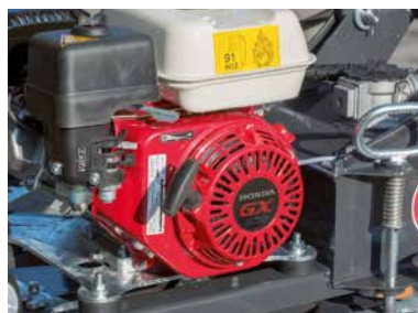
Antrieb über leistungsstarken Benzin- oder E-Motor
