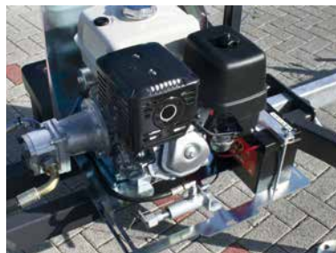
Benzinmotor mit E-Starter (optional)
