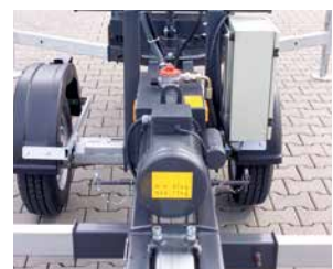
Einschiebbare Achse, Rangierbreite 0,89 m (optional)
