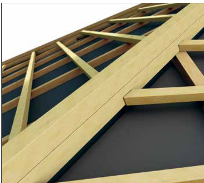
2. változat – Élgerincléc felrakása lécszerkezet segítségével
