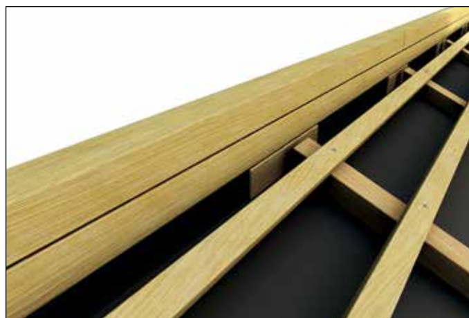
2. változat – Taréjléc felrakása lécszerkezet segítségével
