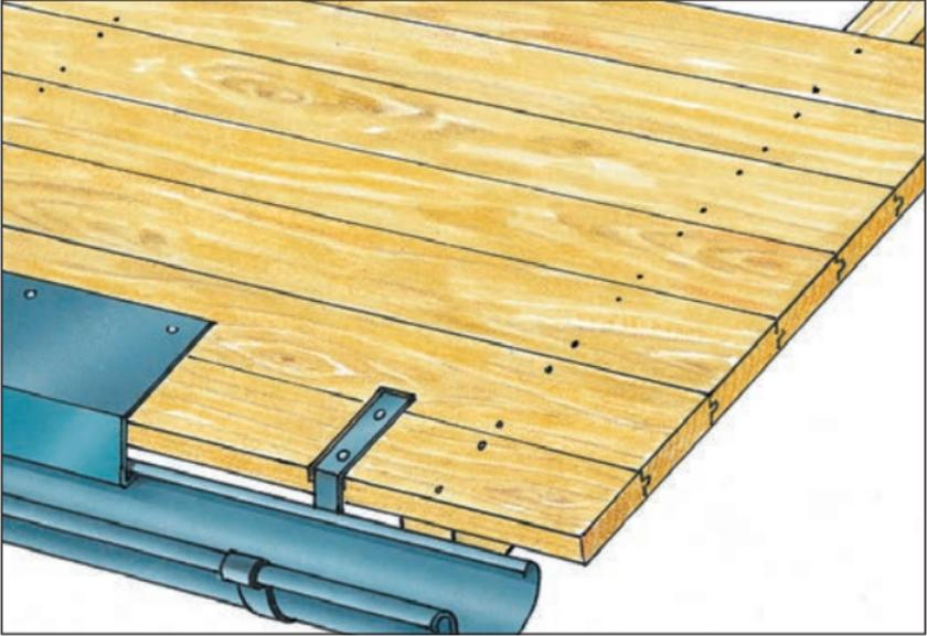
Deckunterlage aus Vollholzschalung mit Traufblech ohne Falzabkantung auf der Dachseite. Rinnenhalter in Schalung einlassen.
