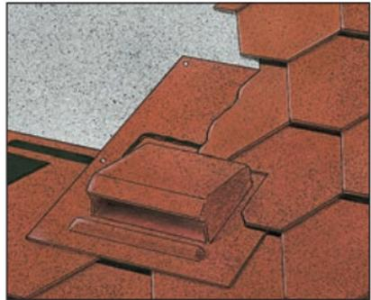
Bitumenschindeln bis zur Aussparung decken. Um die Aussparung, in Größe des Lüfterflansches, Isola Fugenmasse aufbringen und Lüfterflansch befestigen. Seitlich und firstseitig auf den Lüfterflansch Isola Fugenmasse aufbringen und in die Deckung einbinden.
