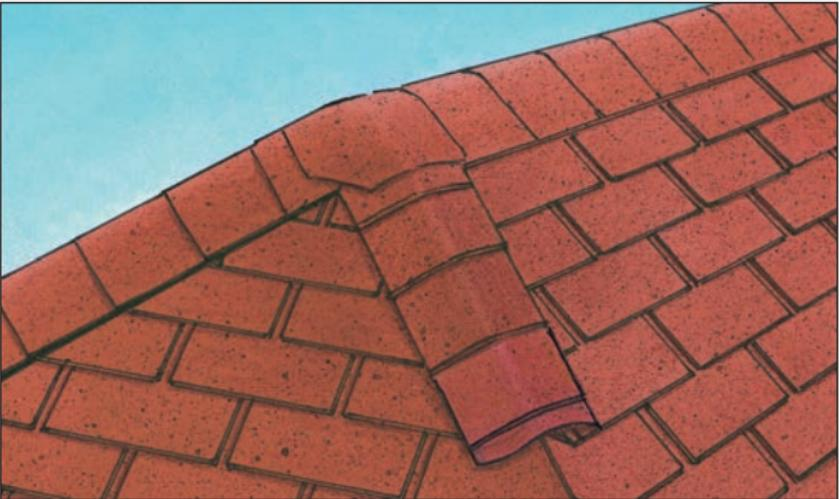
Gratdeckung sinngemäß wie Firstdeckung. Bitumenschindeln der Fläche parallel zur Gratlinie abschneiden und die Schürzen mit wasserabweisendem Schrägschnitt versehen.
