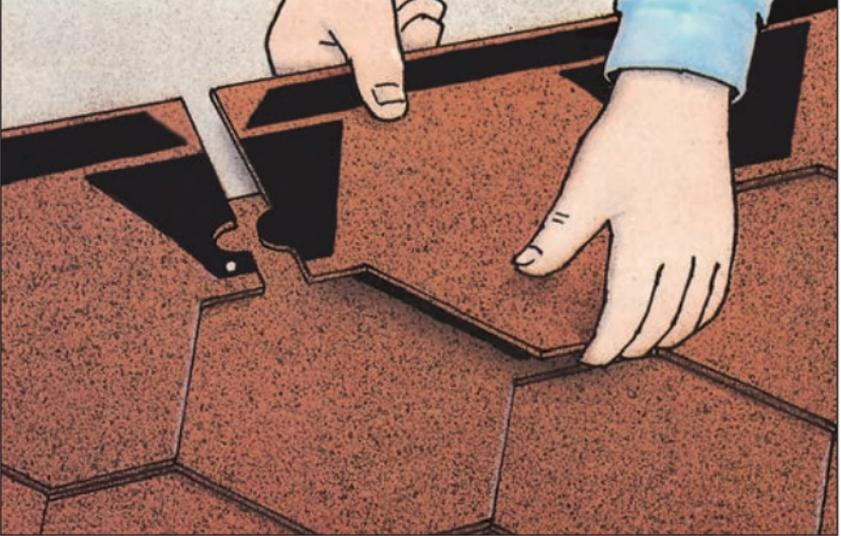
Vereinfachung der waagerechten Deckung. Beidseitige Befestigung an der Stoßfuge.
